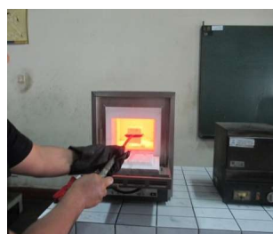
Gambar 2. (a) Kotak karburisasi dalam tungku pemanas, (b) spesimen dari dalam tungku
