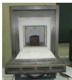
Gambar 2. (a) Kotak karburisasi dalam tungku pemanas, (b) spesimen dari dalam tungku
