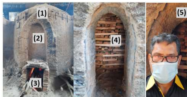
Gambar 1. Foto sistem pengolahan kayu menjadi arang dan asap cair: (1) Tungku, (2) Pintu masuk bahan baku, (3) Sistem pemanasan awal, (4) Susunan kayu didalam tungku, (5) Ukuran tungku relatif terhadap manusia
