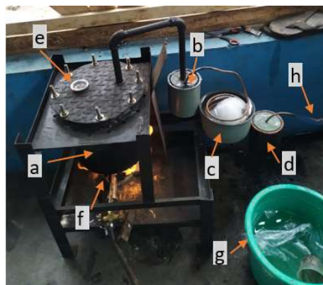
Gambar 7. Sistem pirolisa tempurung kelapa: (a) Tungku pirolisa, (b) Pemisah tar, (c) Kondensor, (d) Tabung pemisah kondensat dan gas, (e) Alat ukur suhu didalam tungku, (f) Sistem pemanas, (g) Es-batu untuk membantu menurunkan suhu pendinginan, (h) Api pembakaran gas
