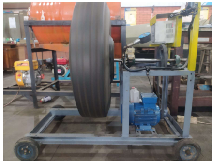
Gambar 1. Skema pengujian kampas rem
