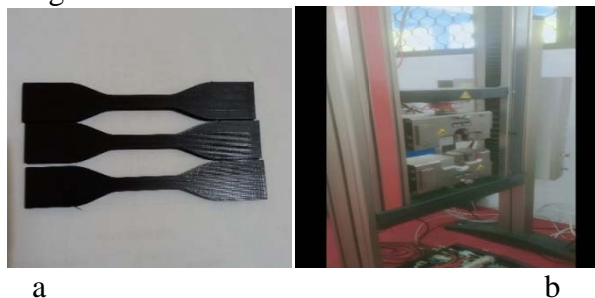
Gambar 3. a. Spesimen uji, b. Mesin uji tarik ( zwick roell )
