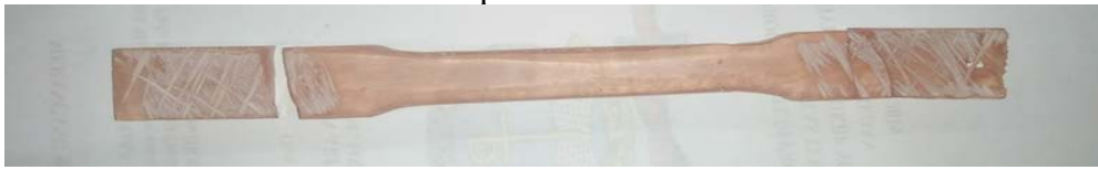
Gambar 5. Tampak patahan spesimen uji tarik tanpa serat
