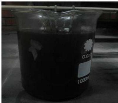
Gambar 6. Pencelupan Spesimen ke dalam larutan asam klorida
