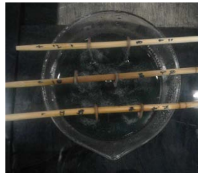
Gambar 5. Pencelupan Spesimen ke dalam larutan asam sulfat
