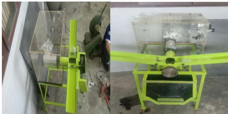
Gambar 2. Mesin Pres Kaleng Berbasis Pneumatik Hasil Fabrikasi
