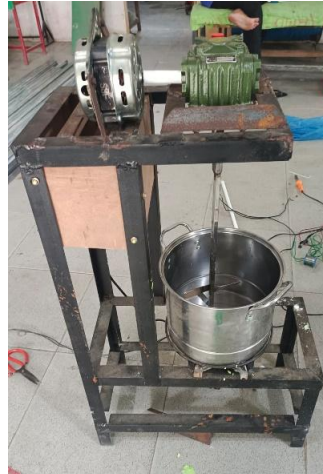
Gambar 1. Mesin pengaduk cendol kapasitas 5 kg
