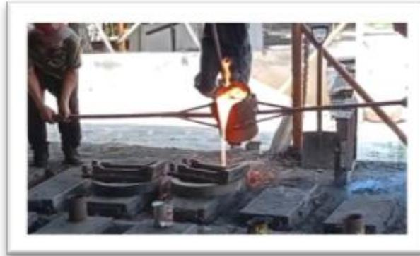
**Gambar 8.** Penuangan Cairan ke Cetakan
