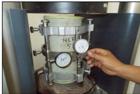
**Gambar 4.** Pengujian Modulus Elastisitas
