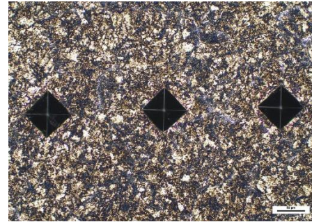
Gambar 30. Struktur mikro dengan media pendingin long life coolant (LLC) dengan larutan etsa 85 ml ethanol, 10 ml HNO_3 dan 5 ml HCL pada perbesaran 200x untuk spesimen ketiga.
