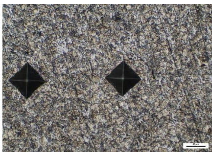
Gambar 4. Struktur mikro tanpa pemanasan dengan larutan etsa 85 ml ethanol, 10 ml HNO_3 dan 5 ml HCL pada perbesaran 200x
