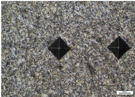
Gambar 2. Struktur mikro tanpa pemanasan dengan larutan etsa 85 ml ethanol, 10 ml HNO_3 dan 5 ml HCL pada perbesaran 200x.
