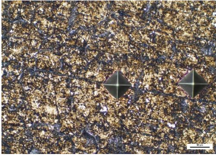
Gambar 26. Struktur mikro dengan media pendingin long life coolant (LLC) dengan larutan etsa 85 ml ethanol, 10 ml HNO_3 dan 5 ml HCL pada perbesaran 200x untuk spesimen kedua.
